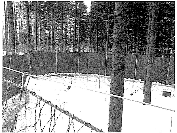
写真-1 支笏湖に設置した小型囲いわな 立木間をワイヤーでつなぎ、カラビナを用いて樹脂ネットをワイヤーに引っかけた。
