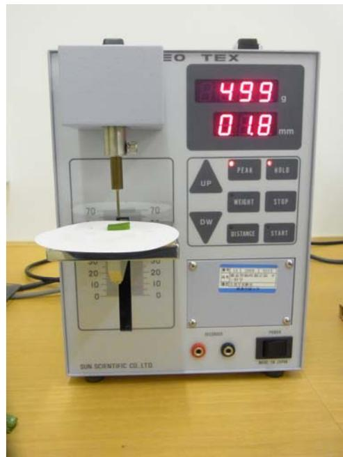
写真 7 若茎表皮の破断強度の測定
