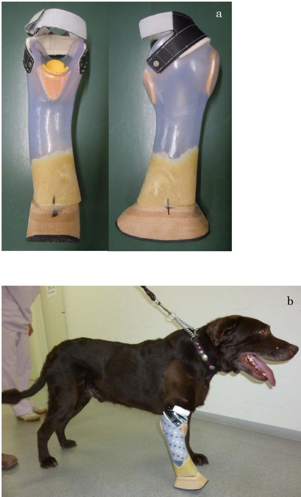
図 23. 3号機の義足 (a、左から正面、側面) および装着時 (b)
