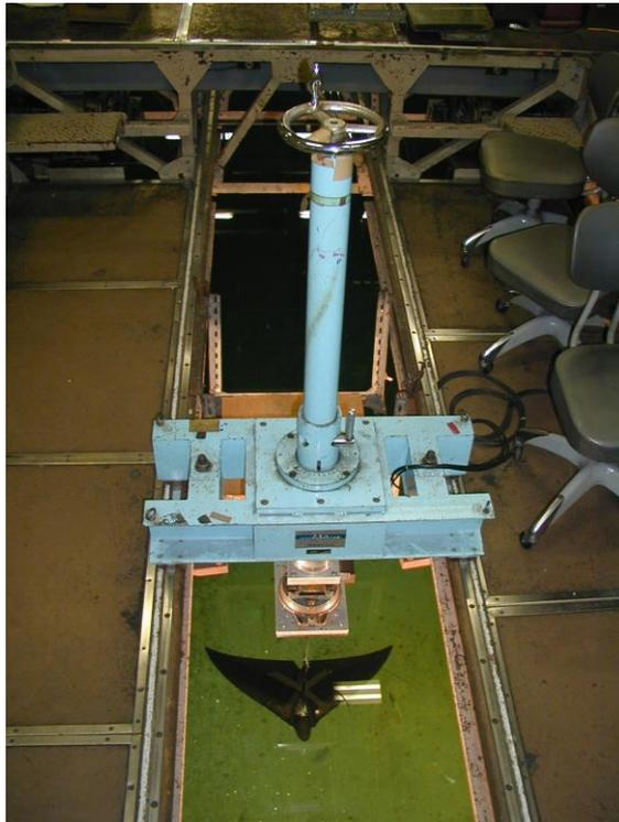
図 96. 実験水槽を用いた人工尾びれの流体特性計測
