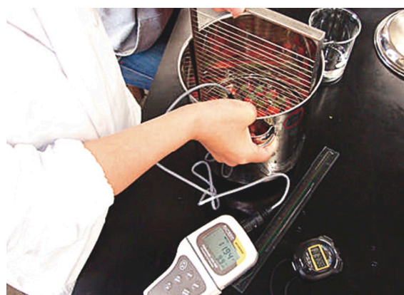
図2 イチゴの導電率を測定している様子
