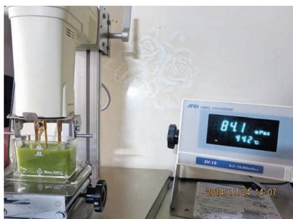
図 17 振動式粘度計
