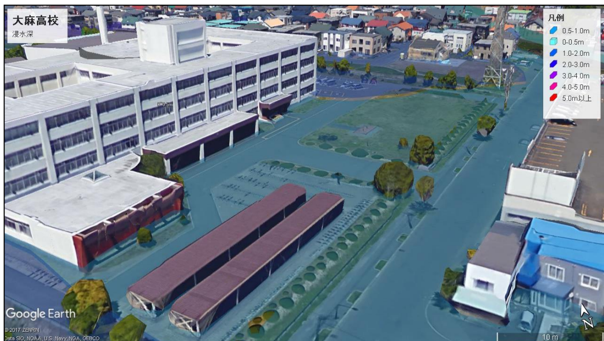
図 29 Google Earth と KML ファイルを利用した大麻高校の水害シミュレーション
