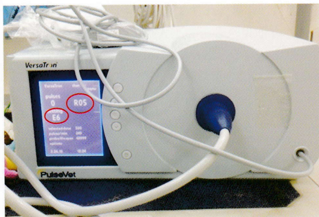
図3. 本院で用いている体外衝撃波装置。スクリーンのE6がエネルギー条件を表しており、R05がプローブの種類を表している。プローブサイズにより、最大到達深度が変わってくる。
