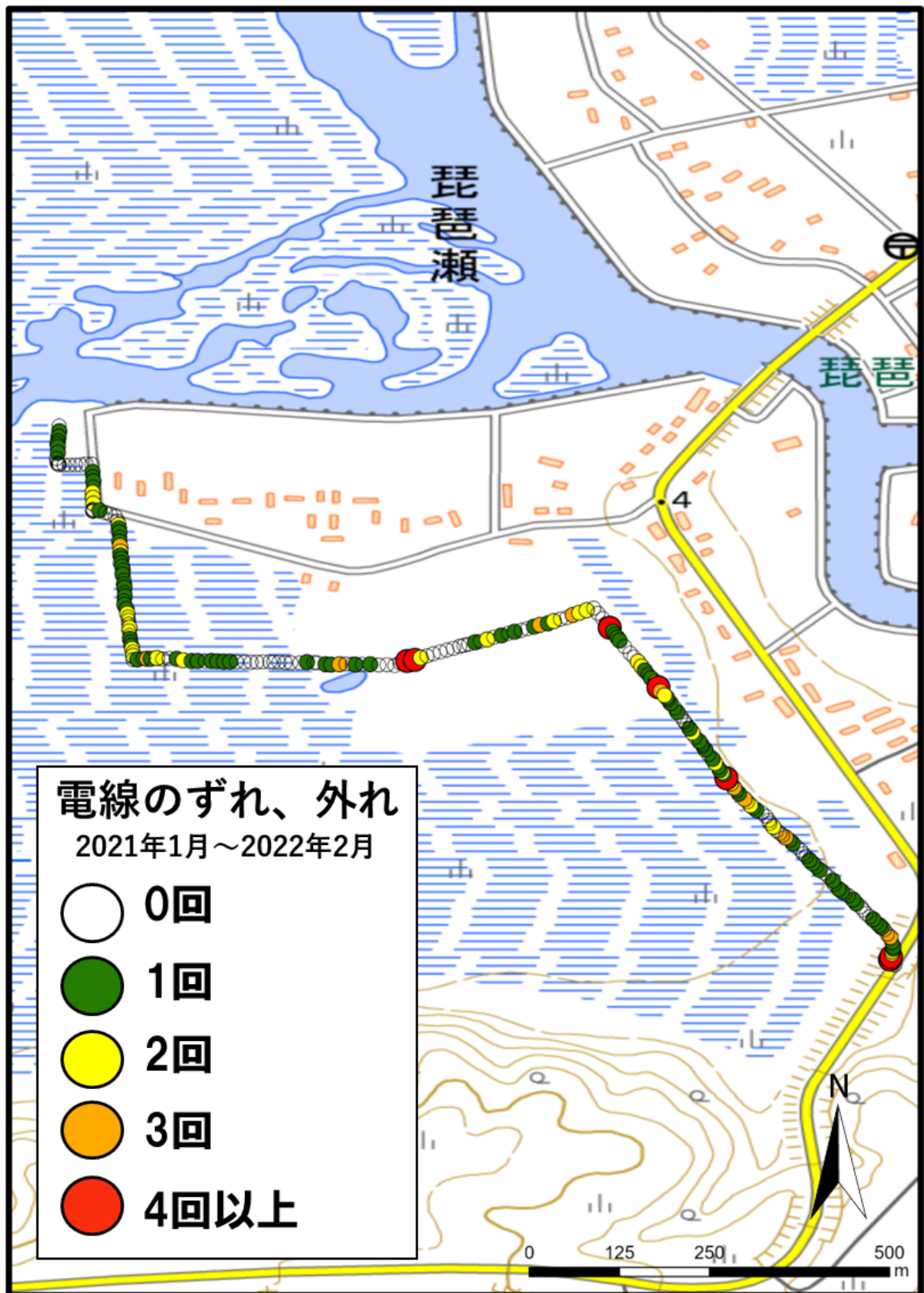
図 3-6. 電気柵点検時の電線のずれ・外れ箇所とその回数
