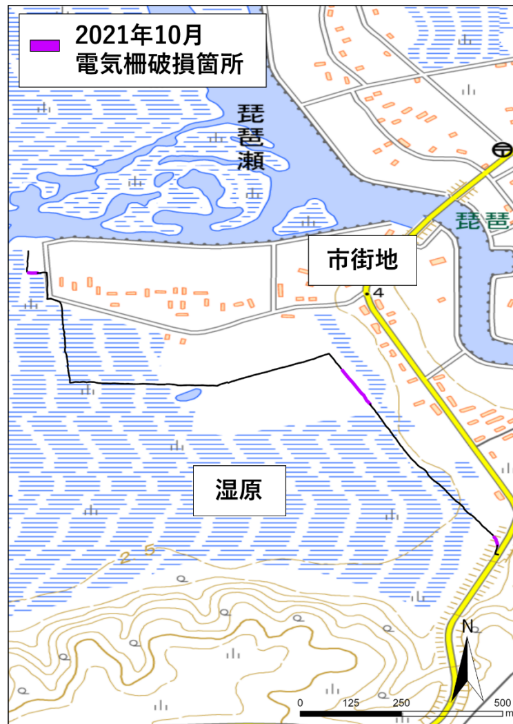
図 4-25. 2021 年 10 月の電気柵破損箇所
