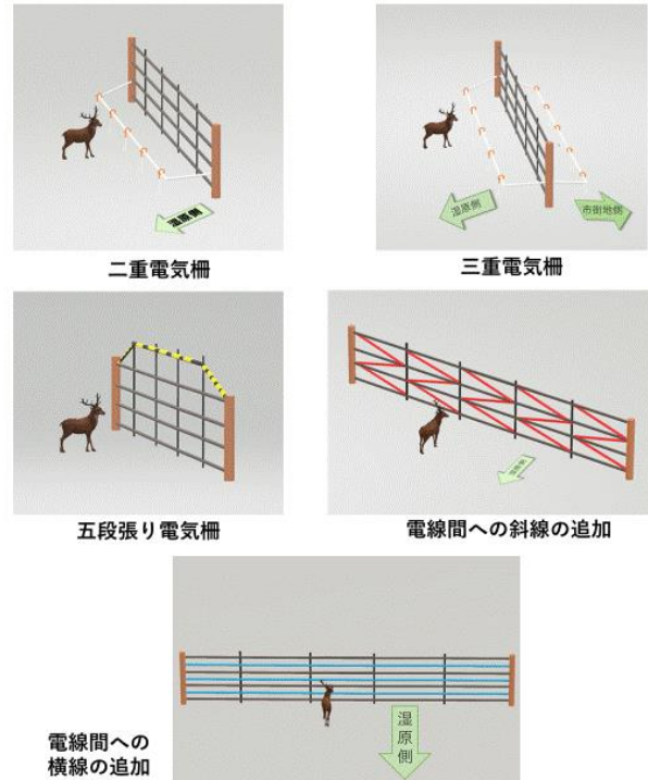
図 1. 通過防止対策実験設置箇所と 5 種類の通過防止対策実験のモデル図
